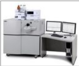
Abb.1: Das Citius LC-HRT-System zum schnellen Nachweis von Schadstoffen in Lebensmitteln. (Bild: Leco)
